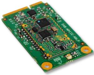
Cette carte se connecte au bus Mini PCI Express et vous permet d'intégrer facilement la technologie Sigfox ou LoRaWAN™ sur vos cartes de développement.
