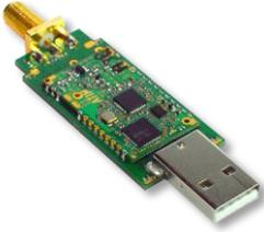
Le dongle USB permet d'intégrer les modules ATIM ARM-Nano à votre carte de développement équipée de ports USB. Branchez-le pour accéder aux réseaux Sigfox ou LoRaWAN™.
