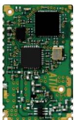
Même form facteur que la gamme de modules ARM, les modules N8-LP et N8-LD sont optimisés pour une communication en mode local en 868 MHz.
