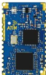
Ultra haute sensibilité : -141 dBm (SF12). Fonctionne à la fois sur LoRa P2P et LoRaWAN.
