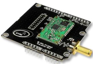
Le shield ACW-DUINO permet de se connecter à des réseaux LPWAN à partir de votre carte Arduino.
